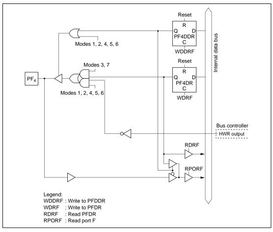
$Figure\ C.11\ (e)\ \ Port\ F\ Block\ Diagram\ (Pin\ PF_4)$
