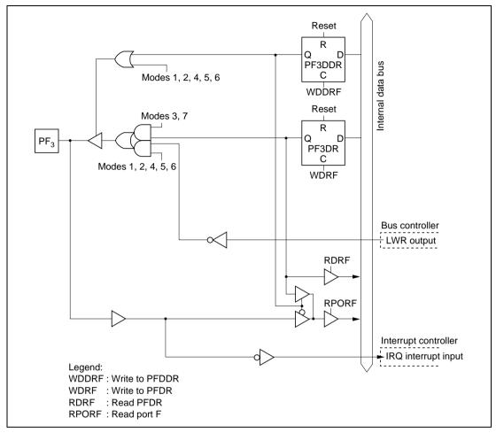
Figure C.11 (d) Port F Block Diagram (Pin PF<sub>3</sub>)
