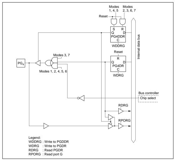
Figure C.12 (d) Port G Block Diagram (Pin PG<sub>4</sub>)
