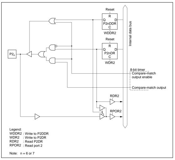
Figure C.2 (d) Port 2 Block Diagram (Pins P2, and P2,)
